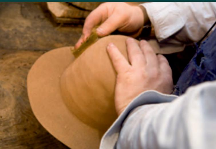
In mehreren Arbeitsschritten - teils mit Handmaschinen, teils von Hand – erhält die Oberfläche des nun fast fertig gestellten Maß – Hutes durch Reiben mit feinstem Spezial-Schmirkelpapier einen seidigen Glanz und angenehmen Griff.
