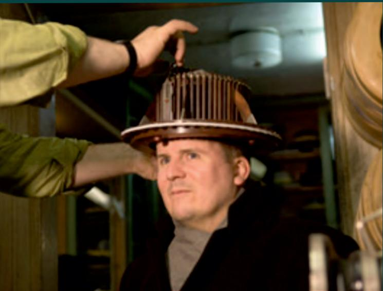
Anschließend wird der entstehende Maß – Hut in einer massiven, traditionellen Handpresse gepresst, die ebenfalls noch original aus der Gründerzeit stammt. Dadurch bekommt der Filz seine Festigkeit. Gleich danach wird die Krone noch von Hand in ihre endgültige Form gebracht.
